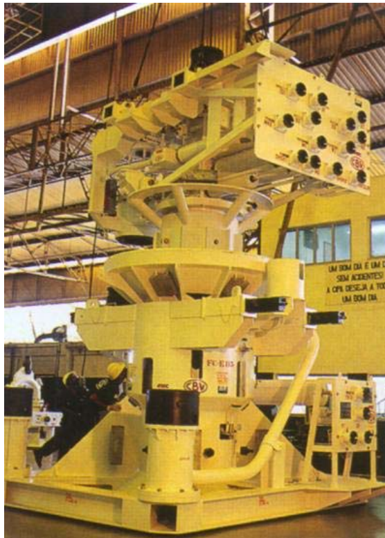
Figura 16. Árvore de natal, usada na Bacia do Roncador, capaz de suportar a pressão de cerca de 2.000 m de profundidade.
