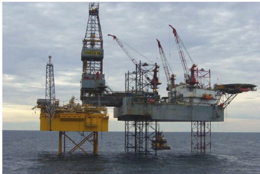
Figura 11. Plataforma auto elevável em área offshore . Fonte: www.miningnews.ne
