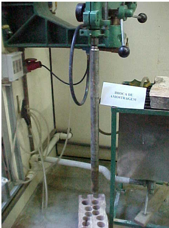
Figura 4-2: Broca diamantada para obtenção dos plugues.
